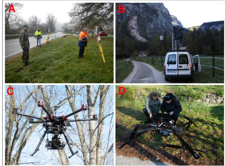
Abb. 1: Übersicht unterschiedlicher Datenerhebungsmethoden. (A) stop-and-go, TLS Vermessung mit einem Stativ, (B) stop-and-go, TLS Vermessung mit einem Fahrzeug (C) hochauflösende photogrammetrische Vermessung unter Verwendung eines ShapeMetriX-UAV (Kamera Sony A7R, Foto A. Gaich), (D) Mobile TLS Vermessung mit einem RiCOPTER, der mit einem Laserscanner VUX-SYS AP20 ausgestattet ist.
